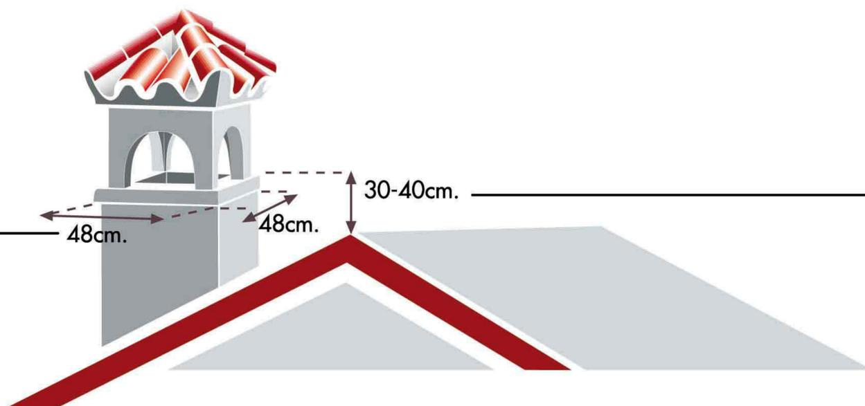
· La altura aconsejable del conducto terminado debe tener entre 30 – 40 cm. aprox. del punto más alto del caballete de cubierta más próximo así evitará reboques de viento ahumado.
