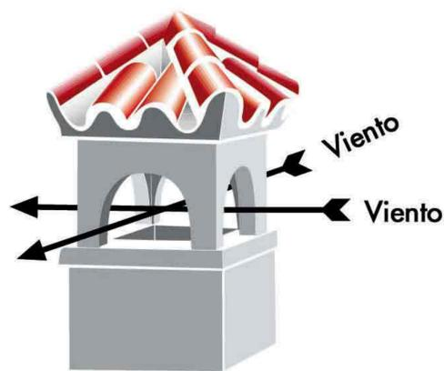
Se pueden utilizar los sombreretes en diferentes tamaños y diferentes colores como terminaciones en partes superiores de ventilación estáticas para buen efecto visual y no interrumpir el procedimiento natural de la aspiración.
